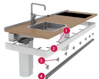
Frontblenden können mittels Winkeln befestigt werden. 1) Winkel 2) Frontblende 3) Beschlag für Klemmschutzleiste 4) Klemmschutzleiste
